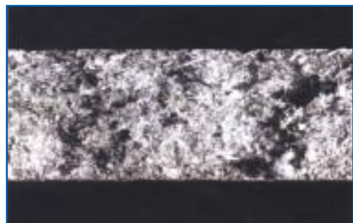
Ίνες χρυσότιλου μέσα στο τσιμέντο σε μια σπασμένη πλάκα αμιαντοτσιμέντου
