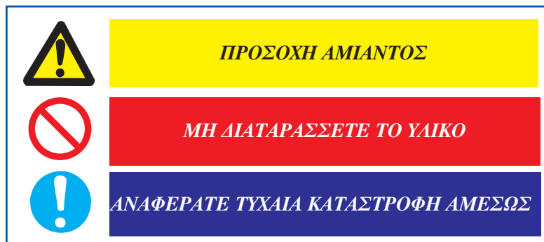
Σήμανση αμιαντούχου υλικού που αφήνεται στη θέση του (ετικέτα)
