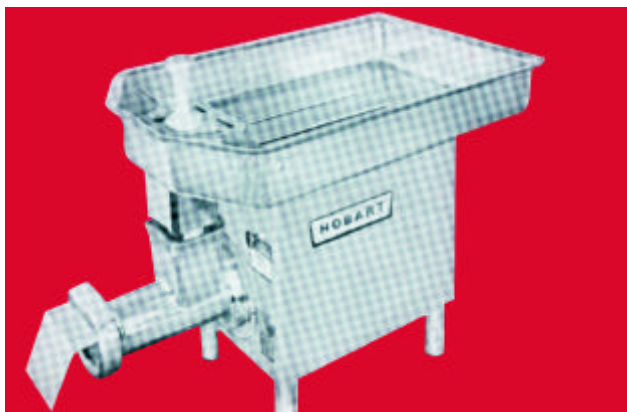
Φωτογραφία 2. Μηχανή κοπής κιμά με προφυλακτήρα
